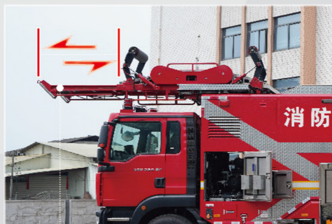
Максимальная длина рабочей платформы составляет 1050 мм
