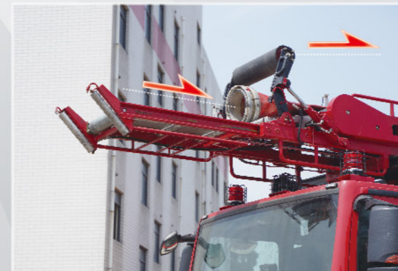
Автоматически поднимается при обнаружении разрыва водяного шланга
